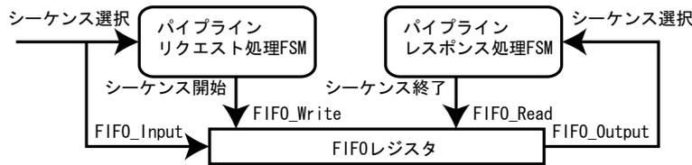
図 17 パイプライン処理 FSM に対する処理シーケンス指定方法
